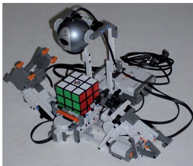
UN ROBOT COSTRUITO CON I KIT DELLA LEGO DA UNO STUDENTE DELLA FACOLTÀ DI INGEGNERIA DELL'UNIVERSITÀ DI SIENA DURANTE IL CORSO DI INTELLIGENZA ARTIFICIALE.
